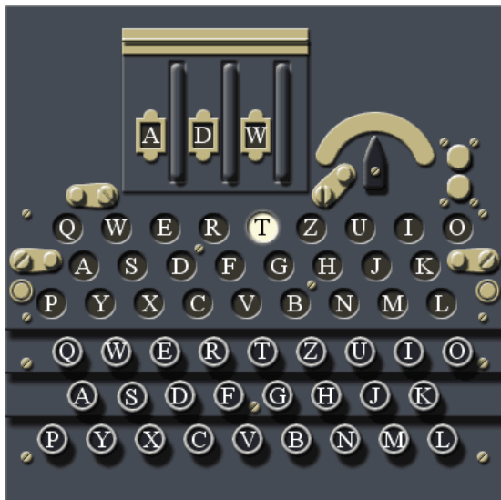
Obrázek 8: Ve spodní části je klávesnice. Nad ní se nachází výstupní signální deska. Úplně nahoře je potom nastavení scramblerů.
